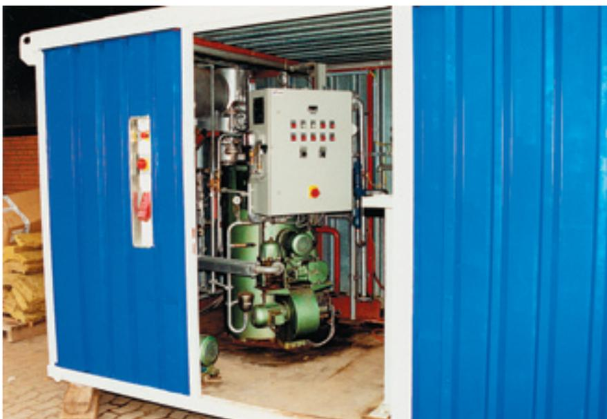
Generatore di vapore per pretensionamento termico
