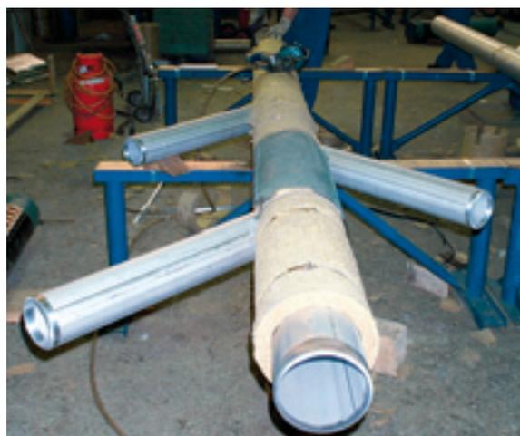
*Irlanda, TUBO FW DI SICUREZZA per acque contaminate DN 100/200, 150/250, 100 °C, 6 bar, tubi di servizio e di rivestimento in acciaio inossidabile*
