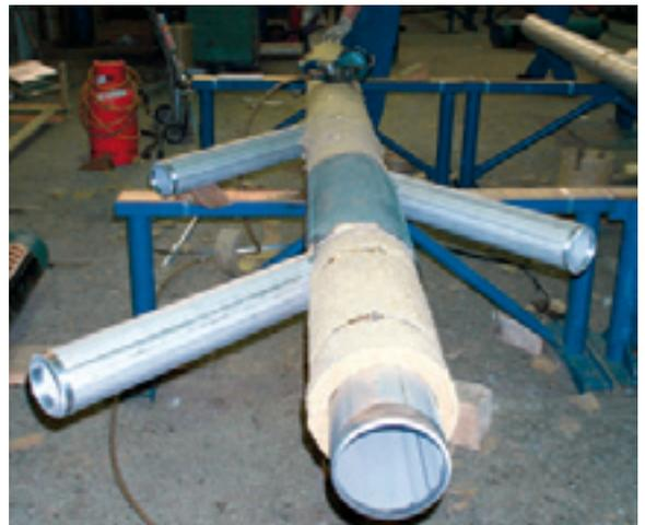
*Irland, FW-SICHERHEITSROHR für kontaminierte Abwasser DN 100/200, 150/250, 100 °C, 6 bar, Innen- und Mantelrohr Edelstahl*
