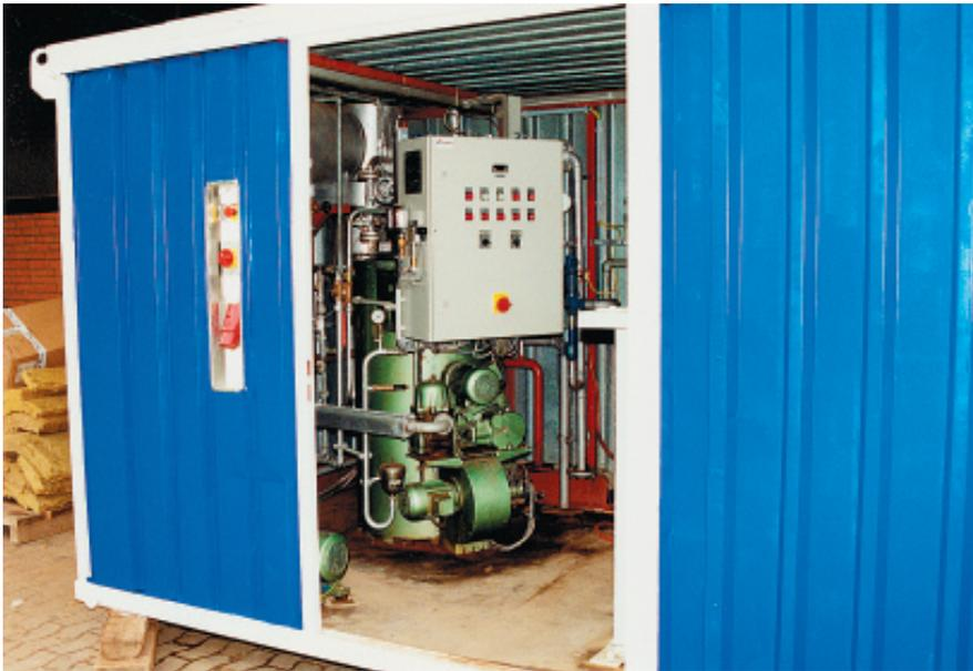
Dampferzeuger für die thermische Vorspannung
