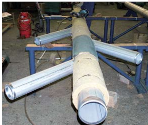
Ирландия, FW-БЕЗОПАСНАs ТРУБА для загрязнённых сточных вод, Ду 100/200, 150/250, 100°С, 6 бар, внутренняя и внешняя труба из нержавеющей стали
