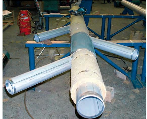
Irlanda, kirlenmiş atık sular için FW-EMNİYET BORUSU DN 100/200, 150/250, 100 °C, 6 bar, paslanmaz çelik iç boru ve ceket boru
